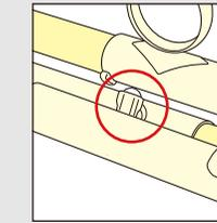
● ピストンとバルブケーシングはミクロン単位による精密な加工により制作されています。お取り扱いには充分ご注意ください。ピストンとバルブケーシングに汚れがたまると動作不良の原因となります。定期的なお手入れを心がけてください。
