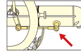
5. BE2028の主管拔差管トリガーは、トリガーアジャスターのネジを緩め、主管拔差管を取り外し、キーオイルなどを使用してください。
