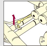
● 一部の機種にワンタッチで着脱可能なトリガーがあります。このシステムのトリガーは強めの力で矢印方向に引きぬいて、キーオイルを使用してください。
