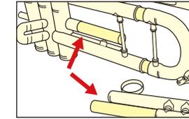
4. バネ式トリガーが装着されている拔差管は、スクリュードライバーで拔差管とトリガーロッドを連結しているネジを取り外し、キーオイルなどを使用してください。
