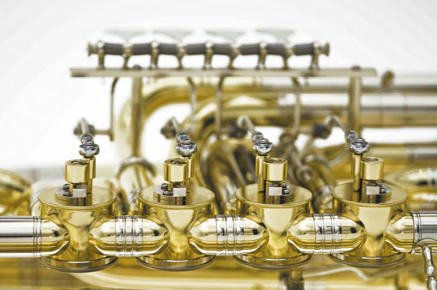
従来のリンケージ・システムに対し、3Bリンケージ・システムは、ブロンズ製のボール・ベアリング内に2つのスチール製の球が包まれた、滑らかな連結を実現するアクション・システムです。3Bとは、ブロンズ (Bronze) ・ボール (Ball) ・ベアリング (Bearing) の3つの単語を指しており、ブロンズ・ベアリングの中にスチール球が入っていることを意味します。また、リンケージは連結のことを意味します。
